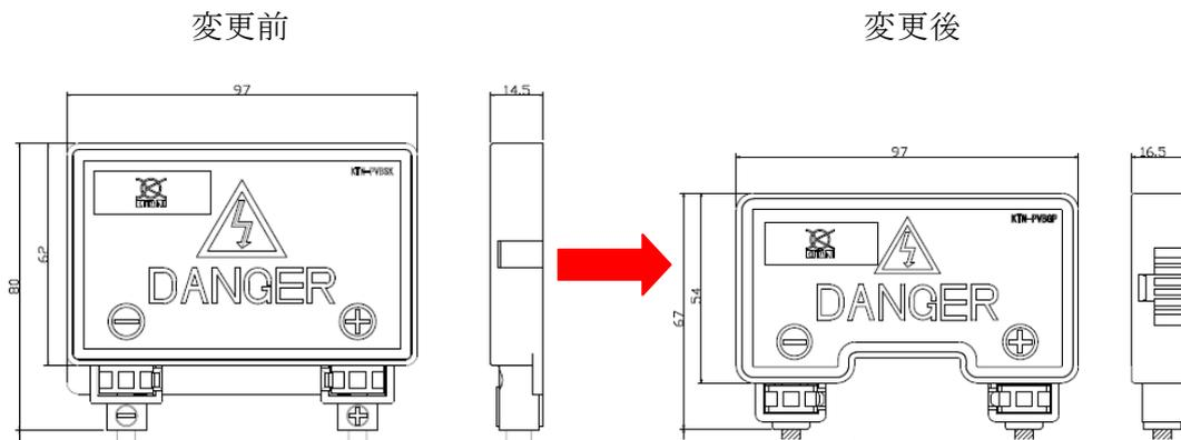
端子箱寸法 97mm×80mm×(H)14.5mm
